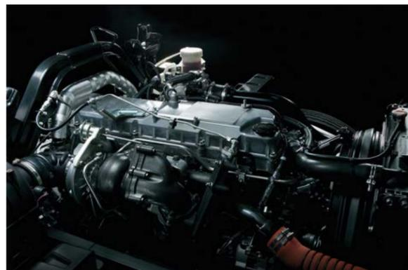
El camión FVZ Corto Euro IV, cuenta con un potente motor 6HK1 TCS de seis cilindros, equipado con turbo de geometría variable e intercooler. Adicionalmente su sistema de inyección Common Rail de alta presión garantiza un óptimo rendimiento.
