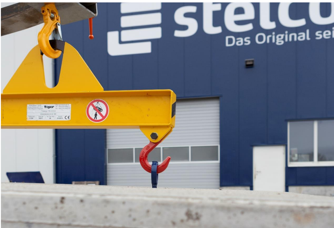
Bild 4: stelcon® Platte an der Traverse
