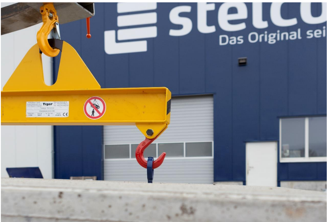
Bild 4: stelcon® Platte an der Traverse
