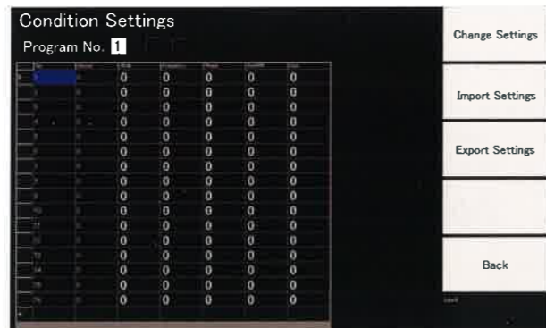
MSK-200の設定画面 一度の測定で16パターンの測定条件で測定できます。
