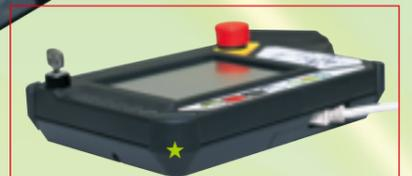
コーナープロテクター(写真★)コントローラの角に装備。万一の落下からコントローラを守ります。
