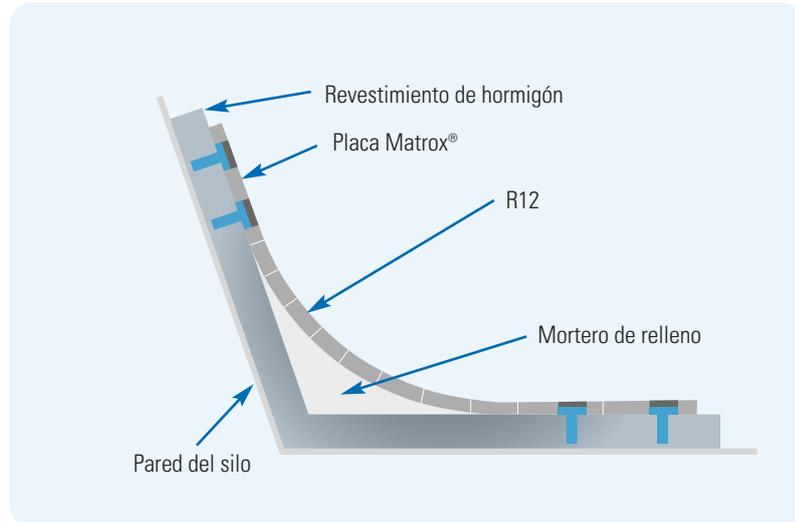
Fijación de un revestimiento de tolva
