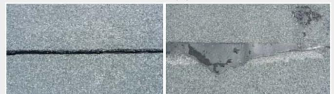
Resultados de soldadura claramente superiores con respecto a equipos con flama
