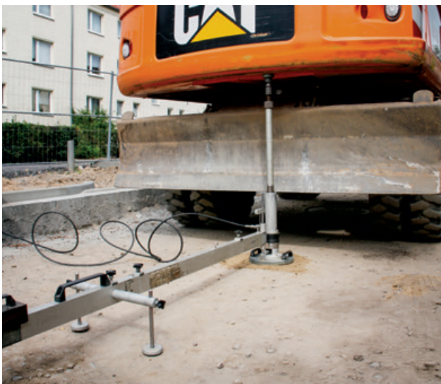
Figura 19 Prueba de placa de carga a DIN 18134 con una placa de carga de diámetro de 300 mm.
