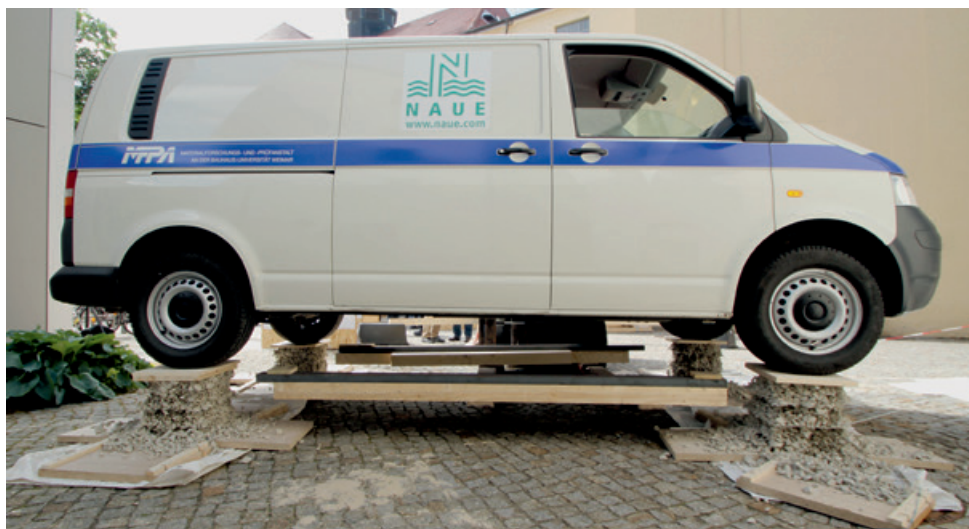
Figura 2 Columnas de piedra reforzadas con geomalla Secugrid® cargan una van de casi 2 toneladas durante un experimento en vivo (consulte http://www.naue.com/en/naue-tv/geogrid-experiment.html )
