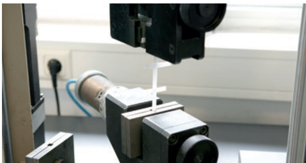
Figura 17 Prueba de resistencia de la unión usando una muestra de geomalla Secugrid®
