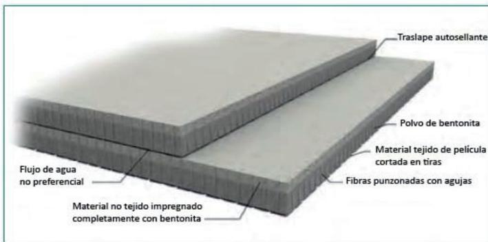
La clave del éxito de BENTOFIX® reside en el proceso de fabricación. La bentonita sódica se encapsula dentro de los espacios vacíos de dos capas de geotextil en un proceso especial de punzonado con agujas.
