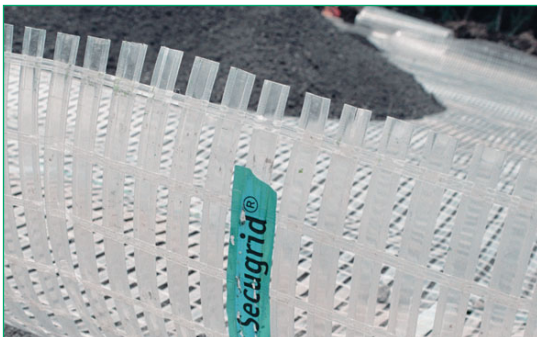
Figura 45 Las geomallas Secugrid® R son apropiadas para aplicaciones de refuerzo uniaxial.
