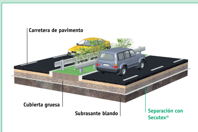
Figura 17: Aplicación de los geotextiles no tejidos Secutex® para separación.
