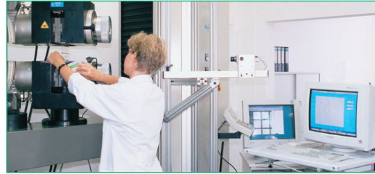
Prueba de resistencia a la tracción de las geomallas Secugrid® (EN ISO 10319).
