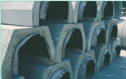
Figure 87 Canales en U de concreto con protección de Secutex® para evitar la elevación.
