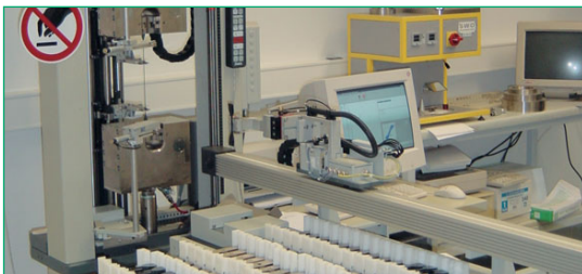
Pruebas de tracción en geomembranas Carbofol® (EN ISO 527).
