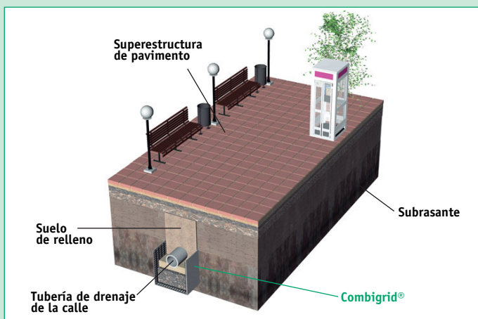
Figura 84: Reforzamiento de una zanja de tuberías
