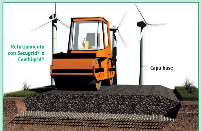
Figura 32: Reforzamiento de la capa base para un camino de acceso de un parque eólico sobre subsuelos blandos.
