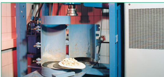
Prueba de carga con placa para la calificación de las capas de protección de geotextil (EN 13719).
