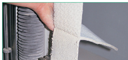
Determinación de la resistencia al desprendimiento de la unión de los revestimientos geosintéticos de arcilla Bentofix® (ASTM 6496).
