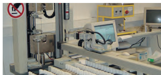
Prueba de tracción en la geomembrana Carbofol® (EN ISO 527)
