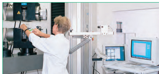
Prueba de resistencia a la tracción de geomallas Secugrid® (EN ISO 10319)
