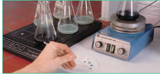
Determinación del contenido de montmorillonita de bentonita mediante el método de adsorción de azul de metileno (titulación) (VDG P69)
