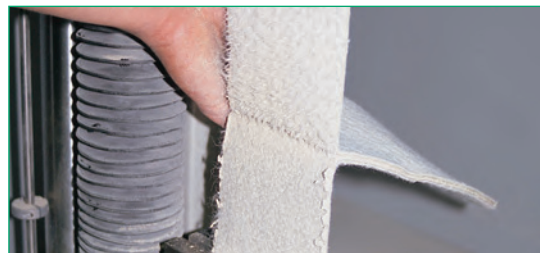
Determinación de la resistencia al pelado de la unión de revestimientos de arcilla geosintéticos Bentofix® (ASTM 6496)
