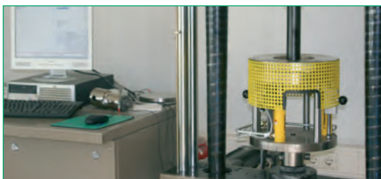
Prueba de punción estática (EN ISO 12236)
