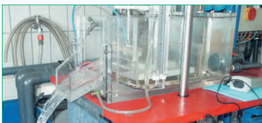
Determinación de la capacidad de flujo de agua en su plano (EN ISO 12958)
