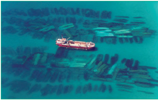
Figura 9 Arrecife artificial como rompeolas hecho de Terrafix Soft Rock® Megacontenedores Narrowneck (Costa de Oro, Australia).
