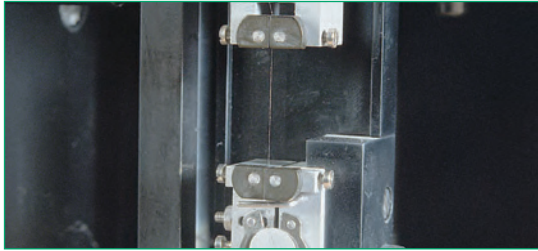
Determinación de las propiedades de resistencia y alargamiento de fibras individuales (EN ISO 5079)
