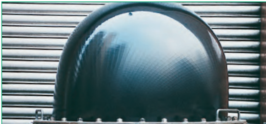
Ensayo de rotura de una geomembrana Carbofol® de acuerdo con EN 14151
