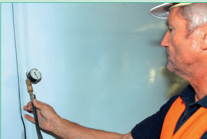
Fig. 33: Prueba de presión de aire de una costura de soldadura de cuña doble
