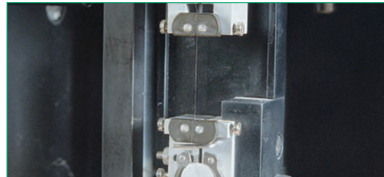
Determinación de las propiedades de resistencia y elongación de fibras sencillas
