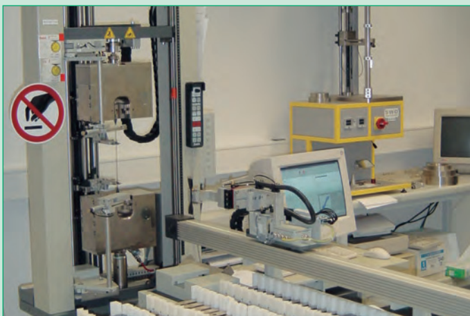
Fig. 7: Prueba de tensión en geomembranas Carbofol® (ISO 527)
