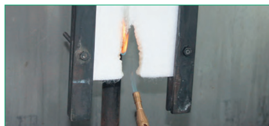
Prueba de flama para determinar la clasificación de fuego E de acuerdo con ISO 11925-2
