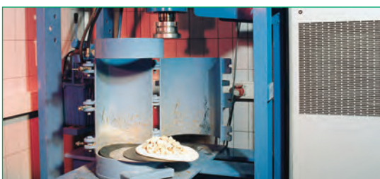
Prueba de carga en placa EN 12719 para la calificación de capas de protección de geotextil
