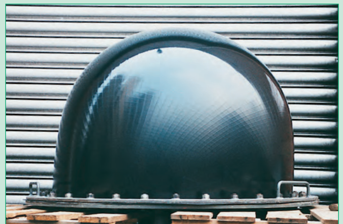
Fig. 8: Prueba de rotura de un Carbofol® de acuerdo con EN 14151
