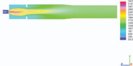
La industria química y de hidrocarburos emplea la dinámica de fluidos computacional (CFD) como herramientas de modelado comprobada para ayudar a diseñar los equipos. Zeeco combina la avanzada tecnología de CFD con nuestra extensa experiencia en el diseño, la fabricación y la operación de equipos de combustión para garantizar el desempeño óptimo del sistema de oxidación térmica.
