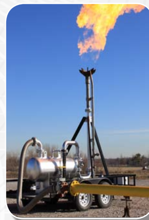
Antorcha de servicio general montada en remolque
