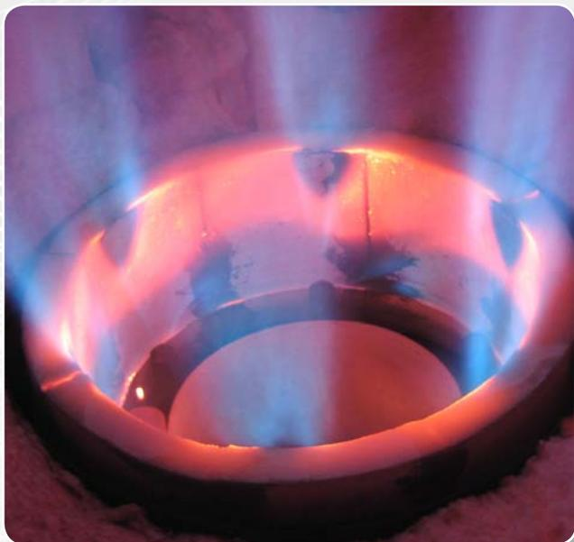
*Quemador combinado AK de aire por etapas con bajas emisiones . En funcionamiento sólo con gas*
