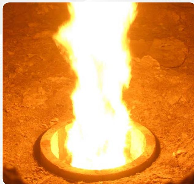
*Quemador combinado AK de aire por etapas con bajas emisiones . En funcionamiento sólo con aceite*
