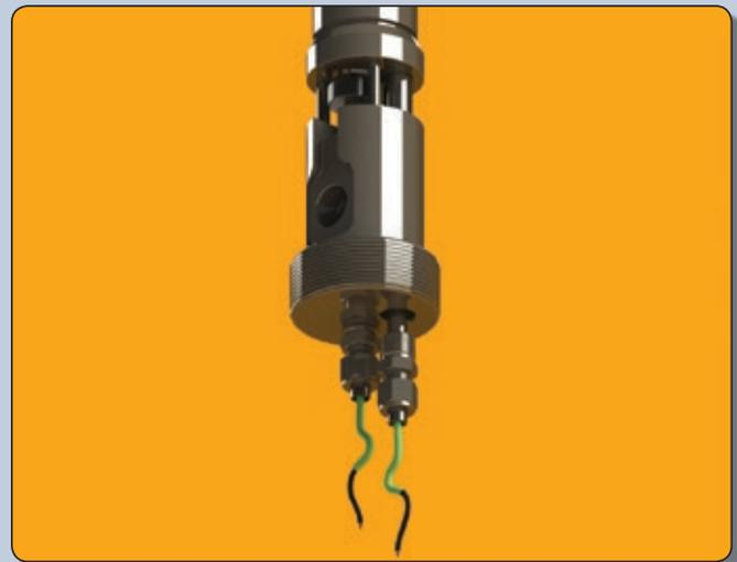
A Série de Pilotos SM incorpora um eletrodo de ionização removível com tubo guia de comprimento total para um preciso posicionamento. Ambos, eletrodo de ionização e a sonda de ignição, são removíveis pela base do piloto sem a necessidade de remover o piloto do queimador.
