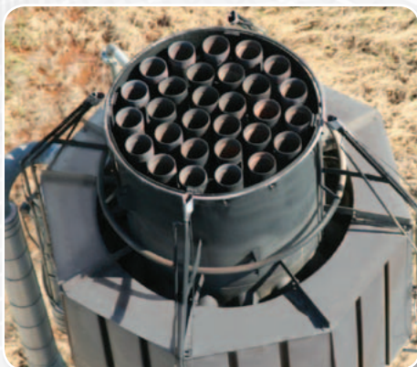
Факельный оголовок HCL с подачей пара
