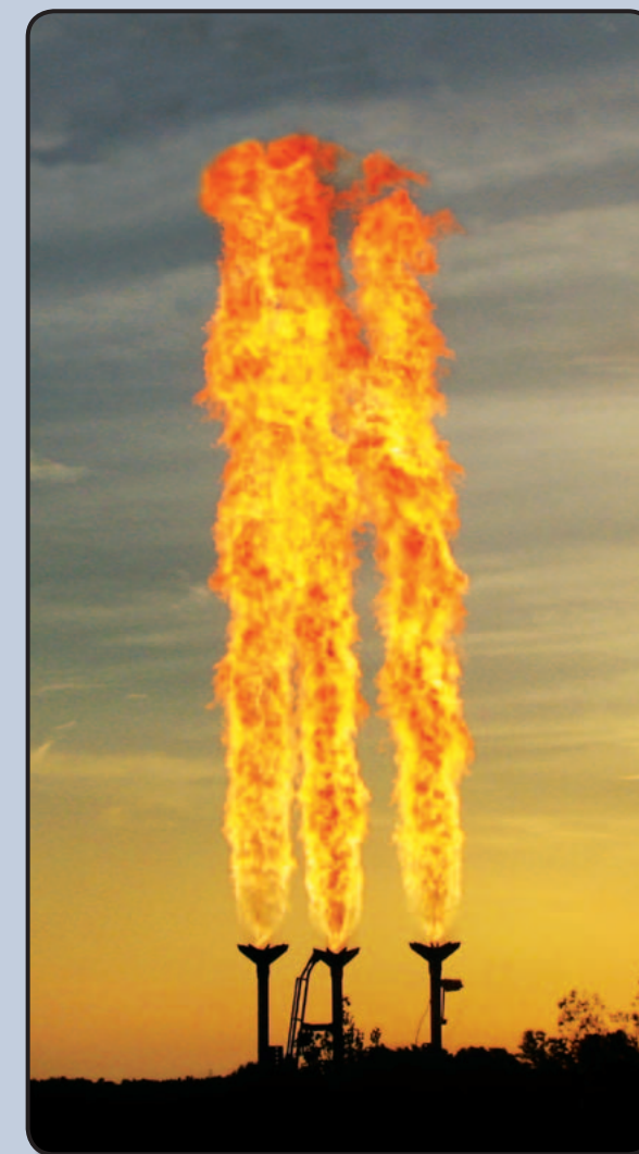
Pruebas de 100% de xileno en la planta de pruebas de Zeeco
