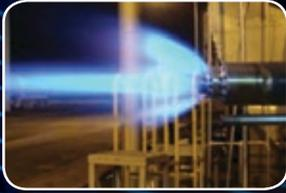
*ZEECOs hochenergetische Pilotbrenner werden umfassend getestet, um zuverlässigen Dauerbetrieb bei großer Beanspruchung zu gewährleisten, und sie können sogar gezündet und befeuert werden, wenn sie vollständig unter Wasser getaucht sind.*
