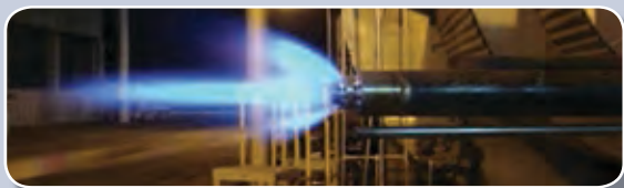
ZEECO 长明灯燃烧器经过完整测试，可确保在恶劣环境中长期可靠运行。
