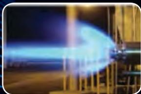
ZEECO<sup>®</sup> 高能长明灯燃烧器通过完全测试，可确保在苛刻环境中长期可靠工作，甚至可在完全潜入水下时仍可点燃并燃烧。
