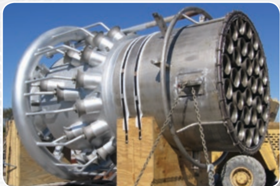
装载于卡车上运送的 HCL 火炬头
