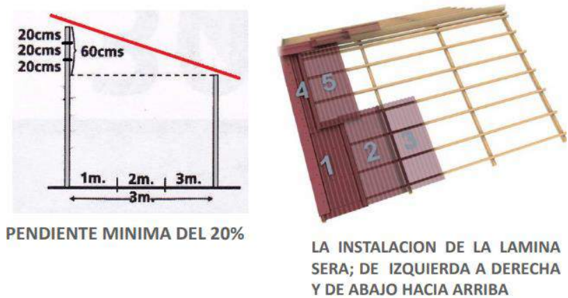
Figura 20. Instalación de láminas de PVC tricapa diseñadas a la medida. En esta imagen se aprecia un ejemplo de instalación de techo con lámina PVC tricapa a la medida requerida.
