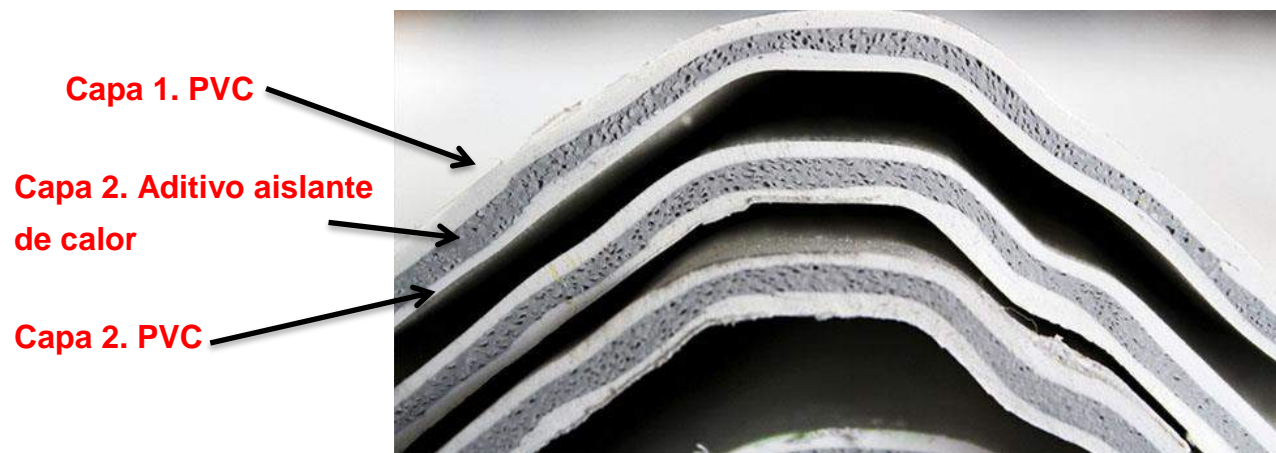
Figura 3. Espesores de lámina tricapa. Se aprecian las capas que conforman la lámina, este ejemplo es de un espesor de 3 mm.
