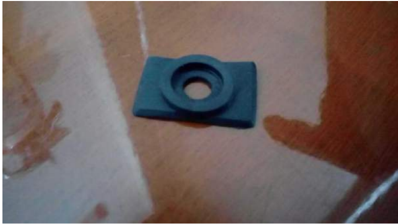
Figura 8. Sello de neopreno. Se aprecia la pieza de goma conocida como sello de neopreno
