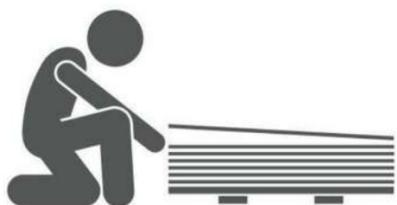
Almacene las láminas bajo cubierta protegiéndolas del sol y la lluvia.
