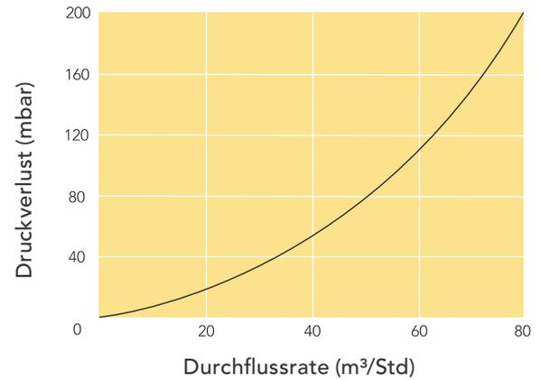
Der Gesamtdruckverlust errechnet sich aus dem Druckabfallwert und dem Druckverlust durch das Filtermedium.
