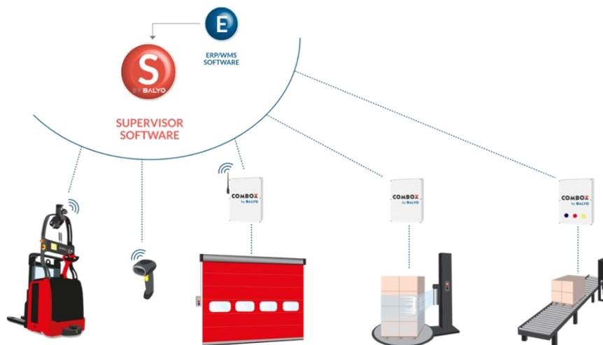
Le système de gestion prend en compte le gabarit des robots, crée le circuit en prenant en compte les informations fournies par l'installateur Balyo (i.e. les zones de stationnement interdites, passages piétons, portes incendie etc...) et optimise la circulation en temps réels des véhicules via un algorithme développé par la Société afin d'éviter les collisions et les bouchons entres robots.
