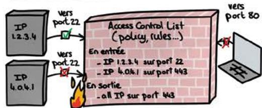
Le firewall à état (stateful packet inspection firewall) analyse le 1er paquet entrant et vérifie que chaque paquet est bien la suite du précédent.
