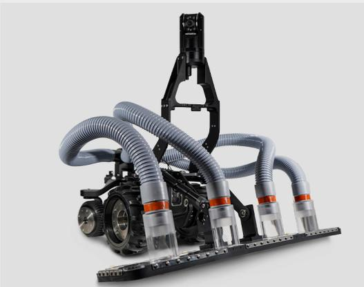
Eleve y baje el cabezal de vacío a 40 grados
