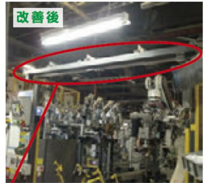
ロボットが原位置になってから3分経つと自動的に消灯するよう回路を変更
