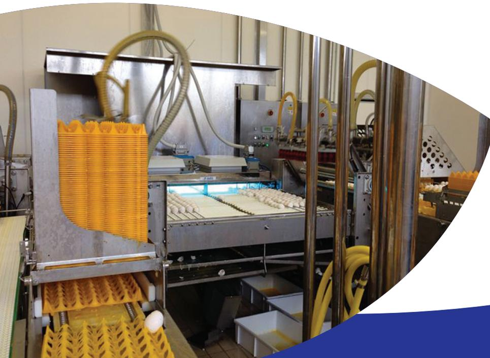
Spezifisch angepasstes UV-Desinfektionssystem auf einer Verarbeitungslinie für Eier. Die maßgeschneiderten Systeme können je nach Bedarf des Betriebes angepasst werden.
