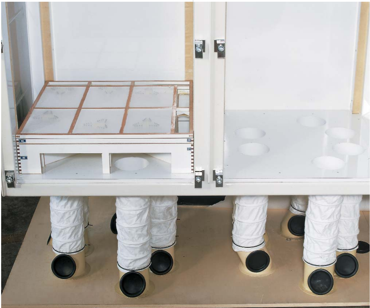
4 Particolare degli scarichi del plansifter Plansifter outlet frame
