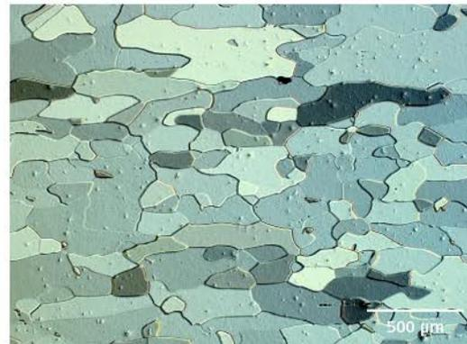
Aluminio grabado Barker, luz reflectada, contraste de interferencia diferencial con luz polarizada circular (C-DIC), objetivo: EC Epiplan-NEOFLUAR 5x/0,13 HD DIC
