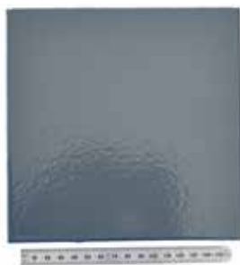
Стальная пластина с покрытием MarineLINE® до механического повреждения молотком.
