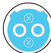
**Le connecteur CHAdeMO** est présent sur les véhicules électriques des constructeurs japonais pour la recharge en courant continu. La plupart des modèles livrées en Europe peuvent aujourd'hui avoir l'option Combo CCS-2.
