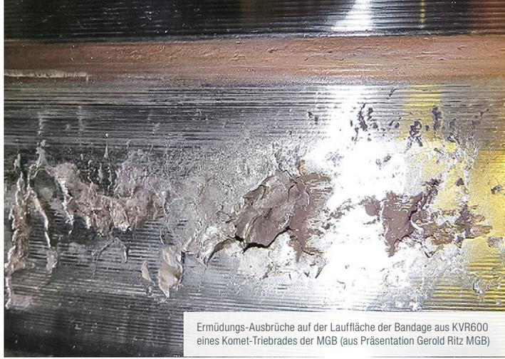
Ermüdungs-Ausbrüche auf der Lauffläche der Bandage aus KVR600 eines Komet-Triebrades der MGB (aus Präsentation Gerold Ritz MGB)
