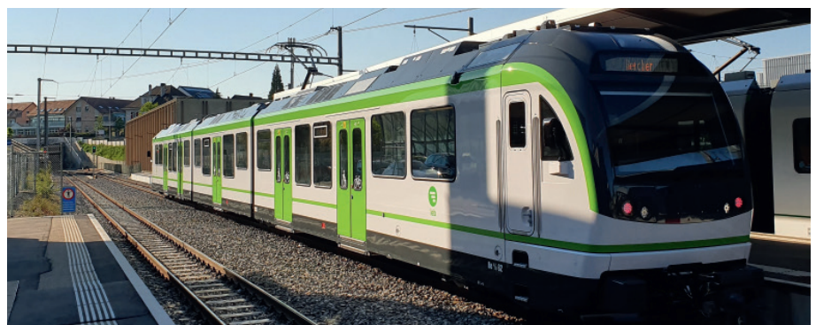
Abb. 7: Einer von sechs ab 2019 ausgelieferten, dreiteiligen Triebzüge des Typs Be 4/8 von Stadler Rail.
