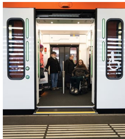
Abb. 2: Alle RBS-Züge sind niederflurig.
