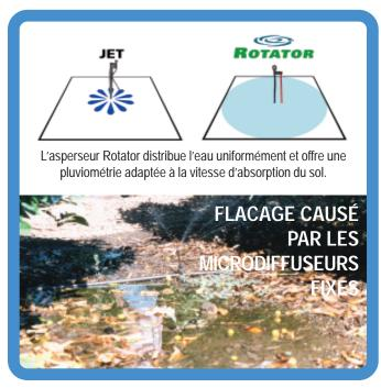
fois de subvenir aux besoins d'ET et d'assurer une distribution délicate de l'eau aux environs de 1 à 3,8 mm/h. Il est possible de parer aux problèmes d'infiltration en combinant un système FCI de Rotators à faible pluviométrie à l'utilisation de blocs de gypse et autres traitements du sol.
