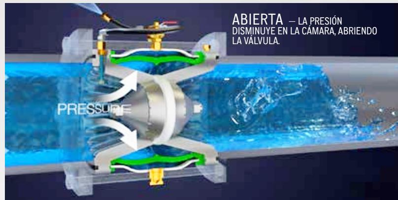
**ABIERTA** — LA PRESIÓN DISMINUYE EN LA CÁMARA, ABRIENDO LA VÁLVULA.
