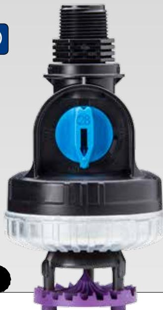
**DISEÑO DESPEJADO.** Caracterizado por un cuerpo de aspersor sin soporte, el nuevo Orbitor Nelson para pivotes proporciona una uniformidad excepcional y gotas óptimas a baja presión (10-20 psi / 0,7-1,4 bar). Mayores robustez y durabilidad en aguas residuales, ya que su diseño despejado previene la acumulación de los residuos.
