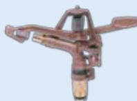
**ARROSEUR À IMPACT P85AS.** Cet arroseur à secteur angle bas est spécialement conçu pour répondre aux exigences d'une opération en bout de pivot, lorsque le débit et la portée requis sont inférieurs à ceux que délivrent les Big Gun® traditionnels. Un diffuseur est disponible en option pour les systèmes à basse pression.
