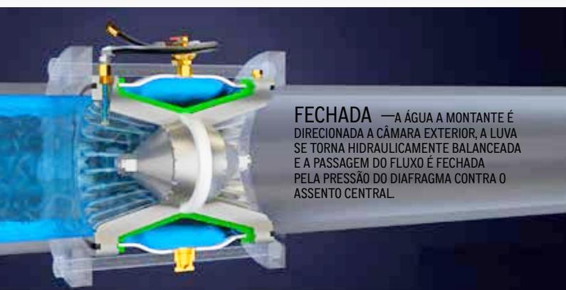
**FECHADA** — A ÁGUA A MONTANTE É DIRECIONADA A CÂMARA EXTERIOR, A LUVA SE TORNA HIDRAULICAMENTE BALANCEADA E A PASSAGEM DO FLUXO É FECHADA PELA PRESSÃO DO DIAFRAGMA CONTRA O ASSENTO CENTRAL.
