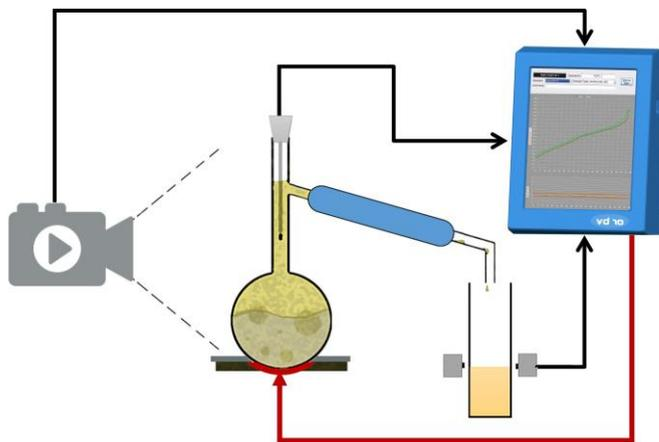
El sistema de video inteligente ayuda al operador a verificar la instalación adecuada del matraz, la sonda y la placa calefactora. El algoritmo de control avanzado VD10 utiliza el análisis de imágenes para controlar perfectamente el proceso de destilación.
