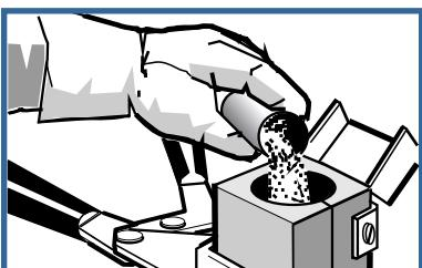
Abrir la tapa de color del cartucho y vaciar el polvo de soldadura en la tolva del molde.
