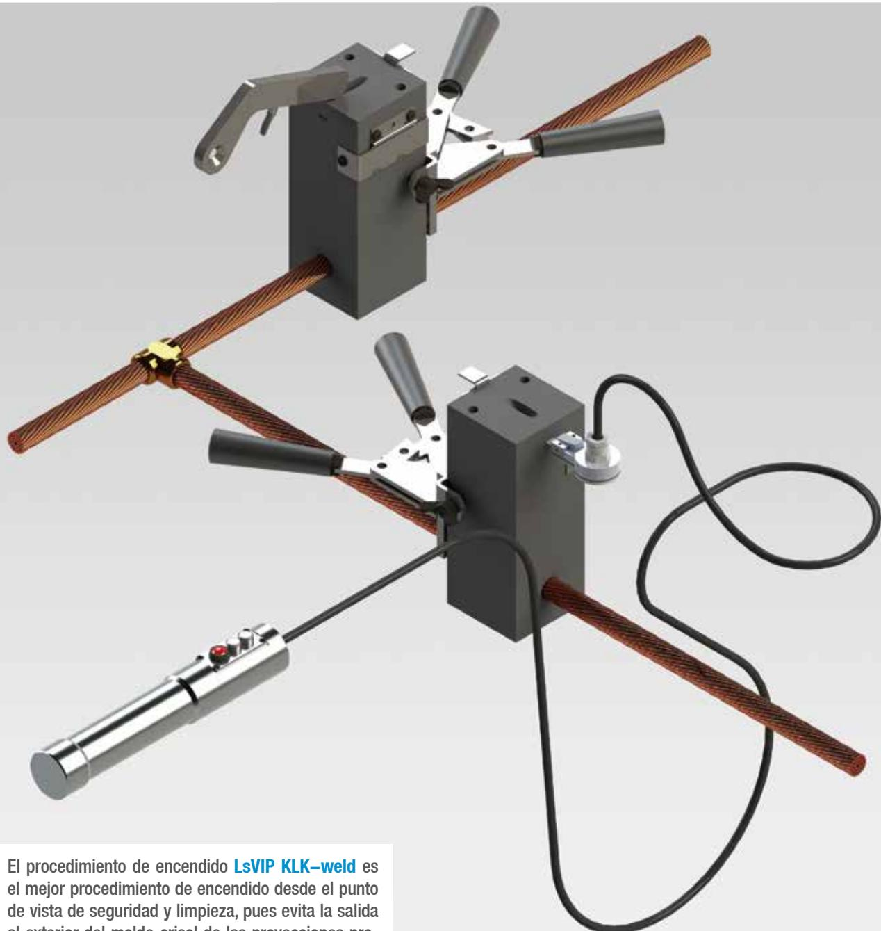
El procedimiento de encendido **LsVIP KLK-weld** es el mejor procedimiento de encendido desde el punto de vista de seguridad y limpieza, pues evita la salida al exterior del molde-crisol de las proyecciones procedentes de la reacción aluminotérmica, reduce las emisiones de humo y además posibilita la realización del encendido a cierta distancia del molde, utilizando para ello el **Dispositivo de Encendido a Distancia KLK-weld**.
