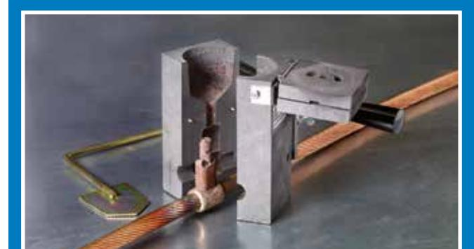
Las conexiones que se consiguen aplicando los procedimientos de soldadura **KLK-weld**, y en particular las que se consiguen tras aplicar el **Procedimiento de Encendido LsVIP**, son conexiones con excelentes conductividad eléctrica, igual o mayor que la de los conductores que se conecten.
