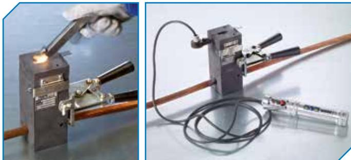
El **Procedimiento de encendido LsVIP** hace uso de una tapa especial que cierra completamente la tolva–crisol del molde, de manera que evita la salida al exterior de las proyecciones procedentes de la reacción aluminotérmica pero al mismo tiempo permite la liberación de sobrepresiones en el interior del crisol. Además la cantidad de humo producido es menor que en otros procedimientos de encendido.
