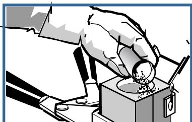
Abrir la tapa negra del cartucho y espolvorear el polvo de ignición sobre el de soldadura y en el borde del molde, bajo la abertura de la tapa, para facilitar su ignición.
