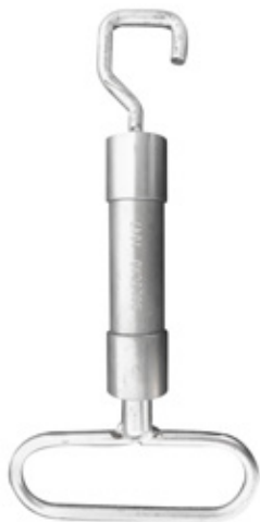
DINAMOMETRO PARA TESTE DO PADRÃO DE ENTRADA, CAPACIDADE NOMINAL 55 daN
