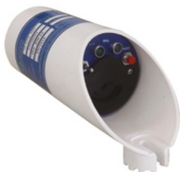
DETECTOR DE TENSÃO POR APROXIMAÇÃO DTA-138
