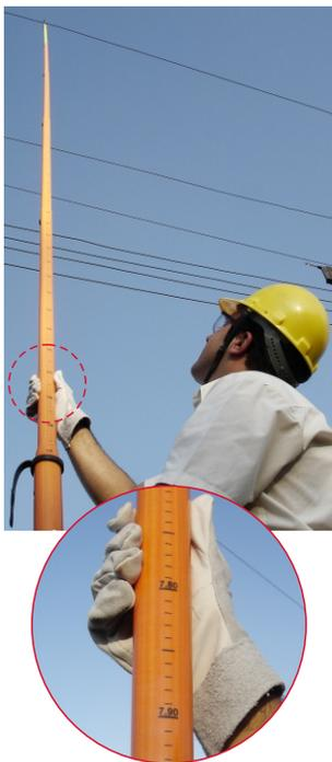
Las VTT-1/2 a VTT-1/9 podrán ser proporcionadas, con graduaciones métrica convirtiendo la pértiga de maniobra telescópica una herramienta para mediciones de espaciamentos verticales.
