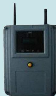
Facilita el mantenimiento detectando fallas en el transformador.
