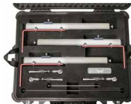
Conjunto de montaje de transductor lineal
