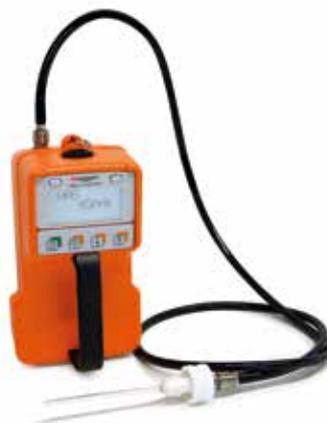
El rastreador de averías es ideal para la localización precisa de averías en cables de redes de baja tensión. Las averías se pueden localizar rápidamente sin interrumpir la fuente de alimentación. El rastreador de averías detecta y mide los gases de quemado a medida que se producen por las averías en cables y muestra su concentración.
