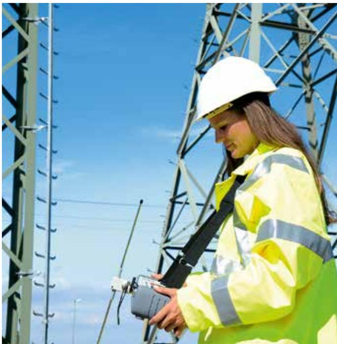
El Detector UHF PDD es la herramienta ideal para inspecciones no invasivas rápidas en subestaciones de MT y AT, y debería formar parte de la caja de herramientas de los equipos de servicio y mantenimiento. Debido a su amplio ancho de banda de medición, el método UHF permite la detección de descargas parciales (DP) online locales en componentes de AT como terminaciones de cables, descargadores de sobretensión, transformadores de tensión y aisladores.
