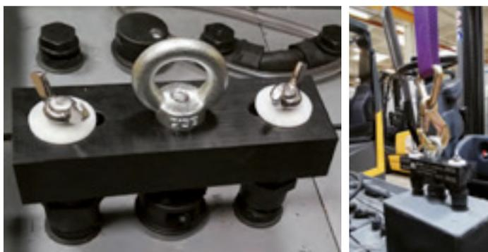
Destornillar el segundo polo de la batería y acoplar el cuerpo con el segundo polo aislante.
