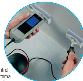
Control en toma 2P+T con punta de prueba en prolongador.
