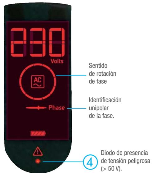
Ejemplo de detección de tensión alterna de 230 V, visualización en **ROJO**.
