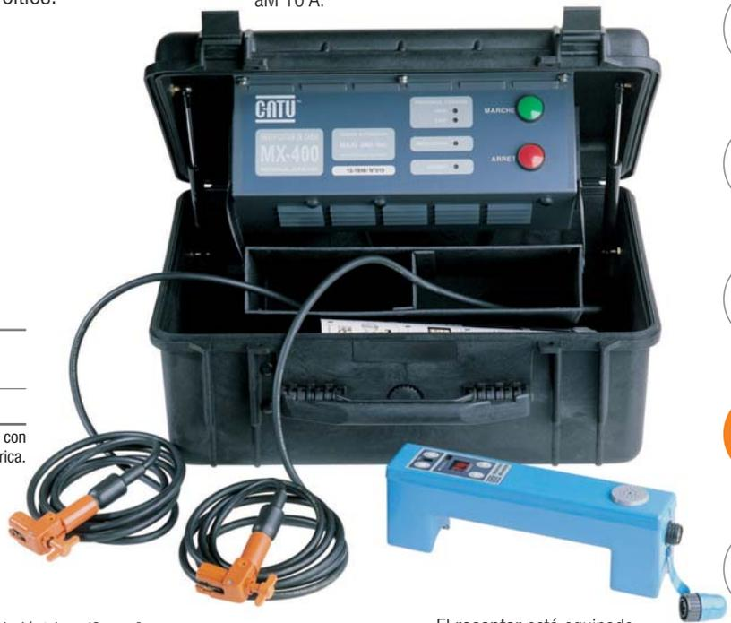
Cables de conexión H07RNF a la red eléctrica. (6 mm<sup>2</sup> y 3 m de longitud). La conexión se realiza entre fases, para la identificación de cable, o entre fase y neutro, en caso de una identificación de fase. Después de la conexión, el aparato está encendido, como indican dos diodos 230 y 400 voltios.
