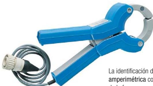
La identificación de la fase se lleva a cabo con una **pinza amperimétrica** conectada al receptor que se colocará alrededor de la fase que se desee identificar. Cuando la pinza detecta los impulsos tomados por el modulador, el receptor emite una señal luminosa que será confirmada al cabo de tres segundos por una señal acústica.
