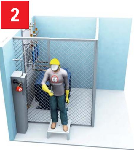
BLOQUEAR CON CANDADO LOS ELEMENTOS DE ACCIONAMIENTO DEL SECCIONADOR EN POSICIÓN ABIERTA E IDENTIFICARLO
